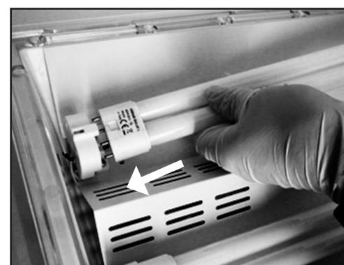
**5.** Insérer le nouveau tube dans la douille et appuyer pour le fixer, le tube doit être identique à celui qui est remplacé. Rabattre ensuite le clip en plastique transparent pour le fermer.
