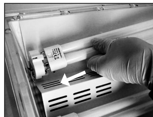
**4.** Nehmen Sie die Röhren heraus: Ziehen Sie den Bügel aus der Fassung und schneiden Sie mit einer Schere die schwarze Klemmschelle durch, die Sie anschließend wegwerfen (sie dient nur einem besseren Halt beim Versand). Halten Sie die Röhre unten fest und ziehen Sie sie heraus.
